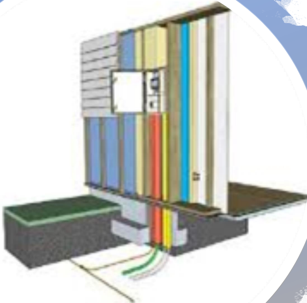
Figur 2 Kabel innføring i vegg til innf
