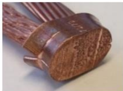
Figur 1 - H- press og Cadweld/termittsveis med god kvalitet. Lite luft
