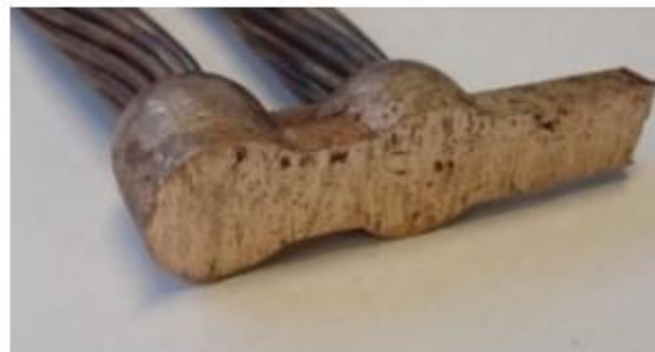
Figur 1 - H- press og Cadweld/termittsveis med god kvalitet. Lite luft
